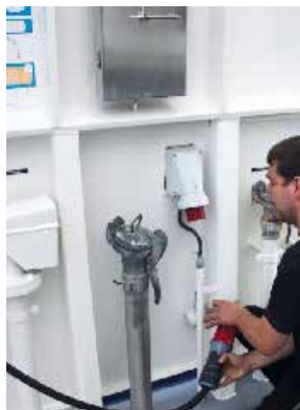
船员连接岸电系统为电池组充电。
